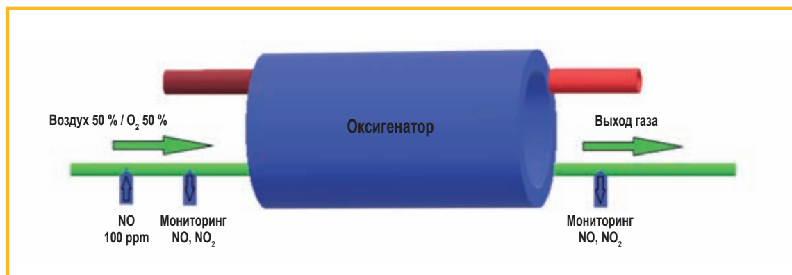
Рис. 1. Схема подачи в оксигенатор кислородно-воздушной смеси, NO и мониторинга NO, NO 2
