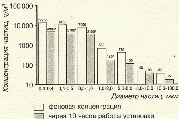
Рис.4. Распределение частиц пыли по размерам в воздухе больничных палат (50 м 3 ) при работе установки "Поток-150М". * — p < 0,05 .
