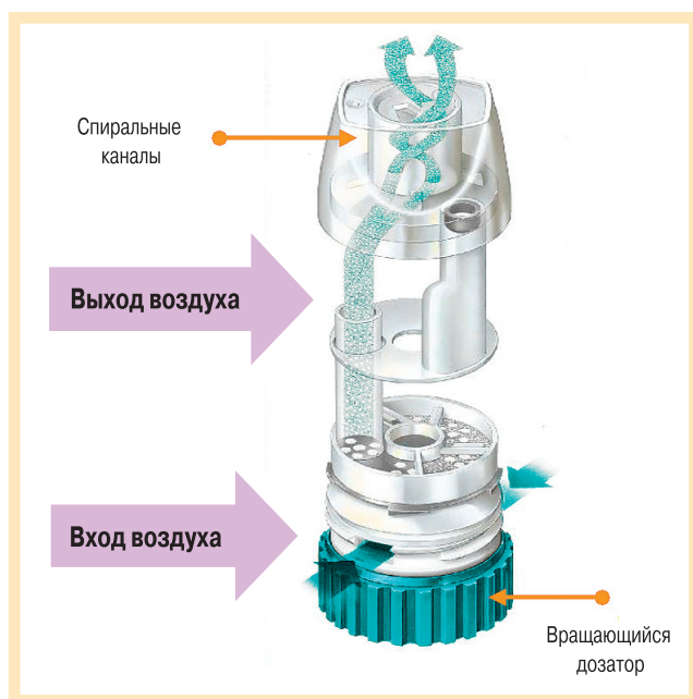
Рис. 2. Устройство порошкового аэрозольного ингалятора Турбухалер: стрелками показан путь воздушного потока через ингалятор (вверху – спиральные каналы)
